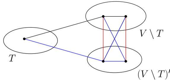
Figura 11: Ilustração da duplicação de um grafo. As arestas pretas são as originais, as azuis são as duplicadas e as vermelhas as que ligam um vértice à sua cópia.
