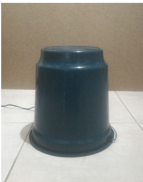
Figura 6.5: Setup do cenário de medição do balde, o Lidaro está localizado dentro do balde
