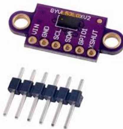
Figura 4.1: Sensor VL53L0X usado no Lidar, o CI está montado sobre o uma placa para facilitar as ligações
