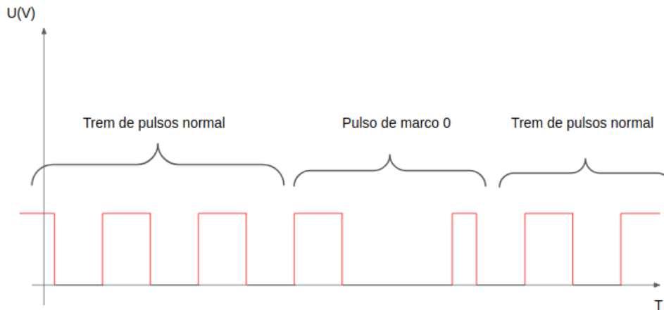
Figura 5.3: Representação de amostra de trens de pulso recebidos pelo sensor IR do encoder, pulsos de duty cycle 50% representam pulsos normais e o que a relação é 25% representa o instante que o dente diferenciado passa pelo encoder marcando o ponto de uma rotação completa
