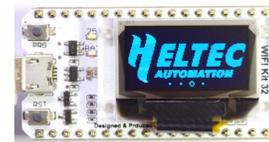
(f) Placa da Heltec utilizada, onde se encontra o microcontrolador ESP32
