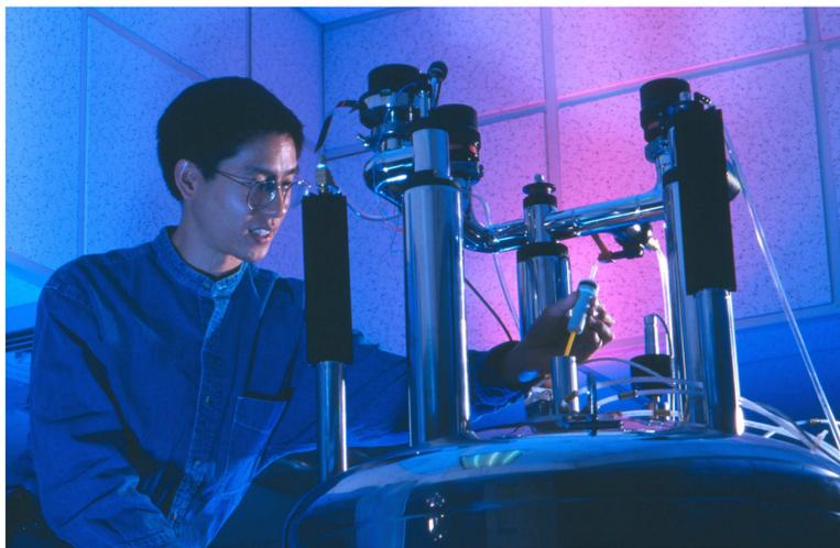
FIGURA 1: Dr. Isaac Chuang, da IBM, e um computador quântico com 7 qubits, construído com a tecnologia NMR (Nuclear Magnetic Resonance), que fatorou o número 15 utilizando o algoritmo de Shor.
