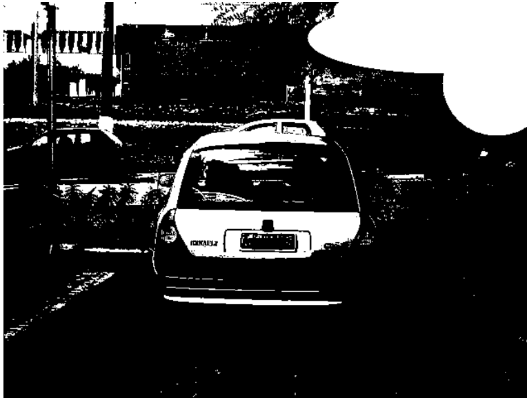
Figura 4: Imagem binarizada por Otsu, em que um pedaço da imagem foi retirado manualmente. Pode-se perceber que esse pedaço em branco fez com que o algoritmo escurecesse outras partes da imagem.
