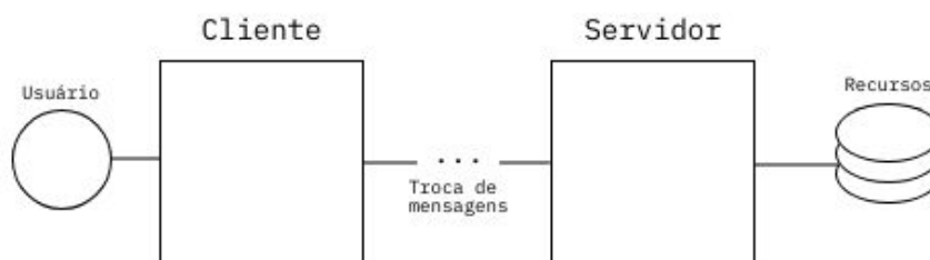
Figura 1.1: Restrição de cliente-servidor.
