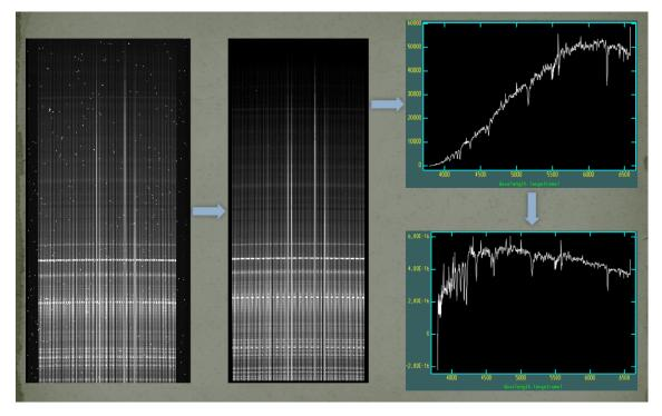
**Figura 2.4:** Redução de dados de uma imagem de CCD a um espectro unidimensional (Moravec, 2004)
