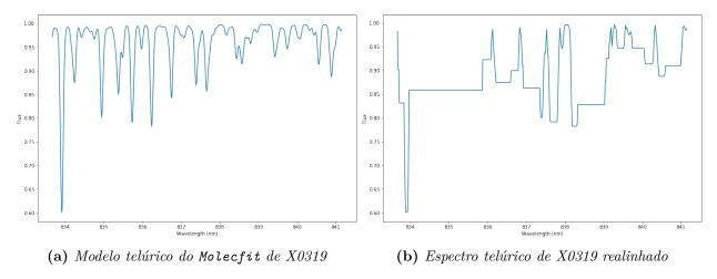
**Figura 3.16:** Espectro telúrico de X0319 e espectro telúrico realinhado a partir do caminho do DTW no intervalo de 834nm a 841nm
