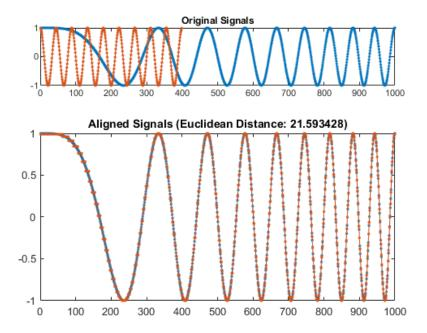
Figura 2.7: Sinais originais e alinhados com a DTW com a distância euclideana final (MATLAB)
