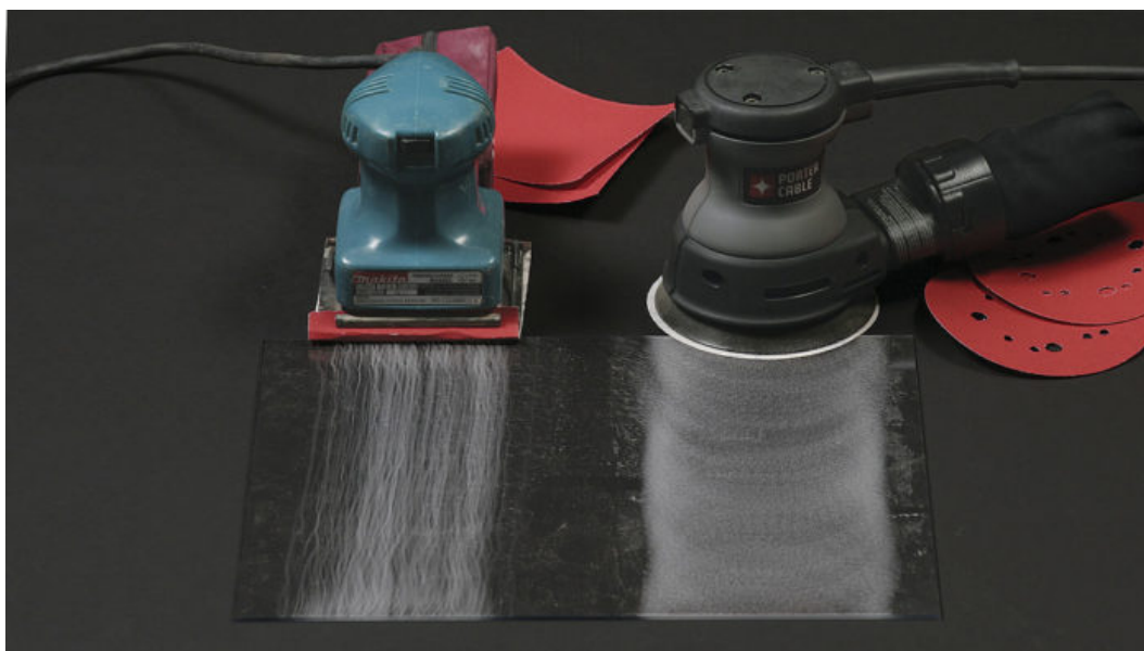
Figura 1.1: Diferença entre o padrão gerado por uma lixadeira orbital a esquerda e uma roto-orbital a direita.
