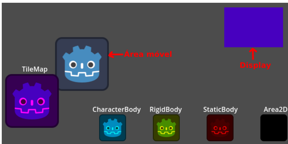
Figura 3.5: Cena de teste para detecção de área 2D (versão Pré-Alpha). A Área móvel destacada na imagem é controlada por teclado, de forma que quando ela colide com algum dos objetos colocados na cena, uma regra é disparada e o Display passa a ter a mesma cor do objeto detectado.
