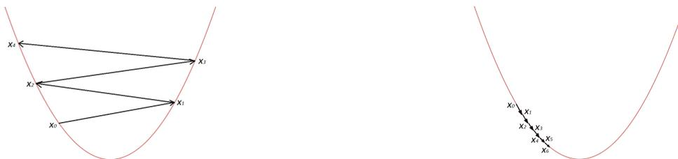
**Figura 2.4:** Se  $\alpha$  for muito alto, a diminuição se torna instável ou pode nem ocorrer (a esquerda); se for muito pequeno, se torna precisa, porém lenta (a direita). Curva representando função de erro desenhada com <https://www.desmos.com/calculator>
